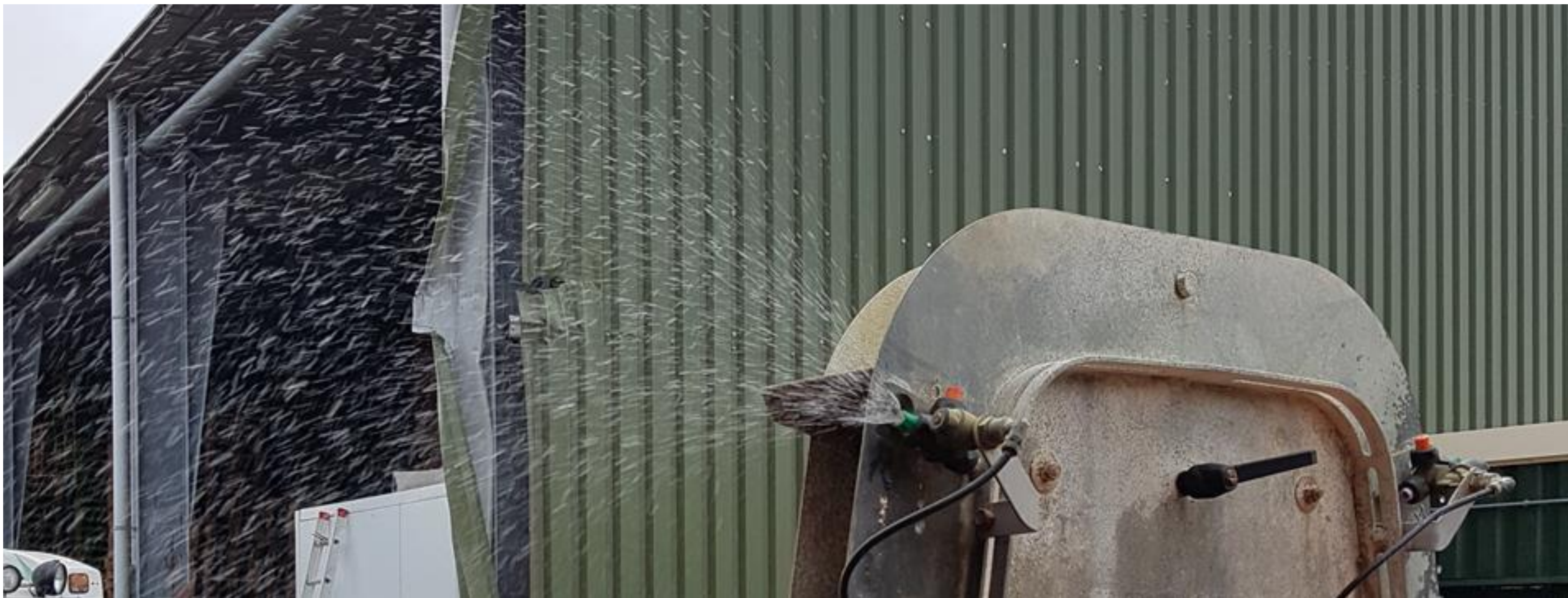
Foto: spuitbeeld bij toepassing van bait spray met dwarsstroomspuit met venturidop zonder luchtondersteuning.
