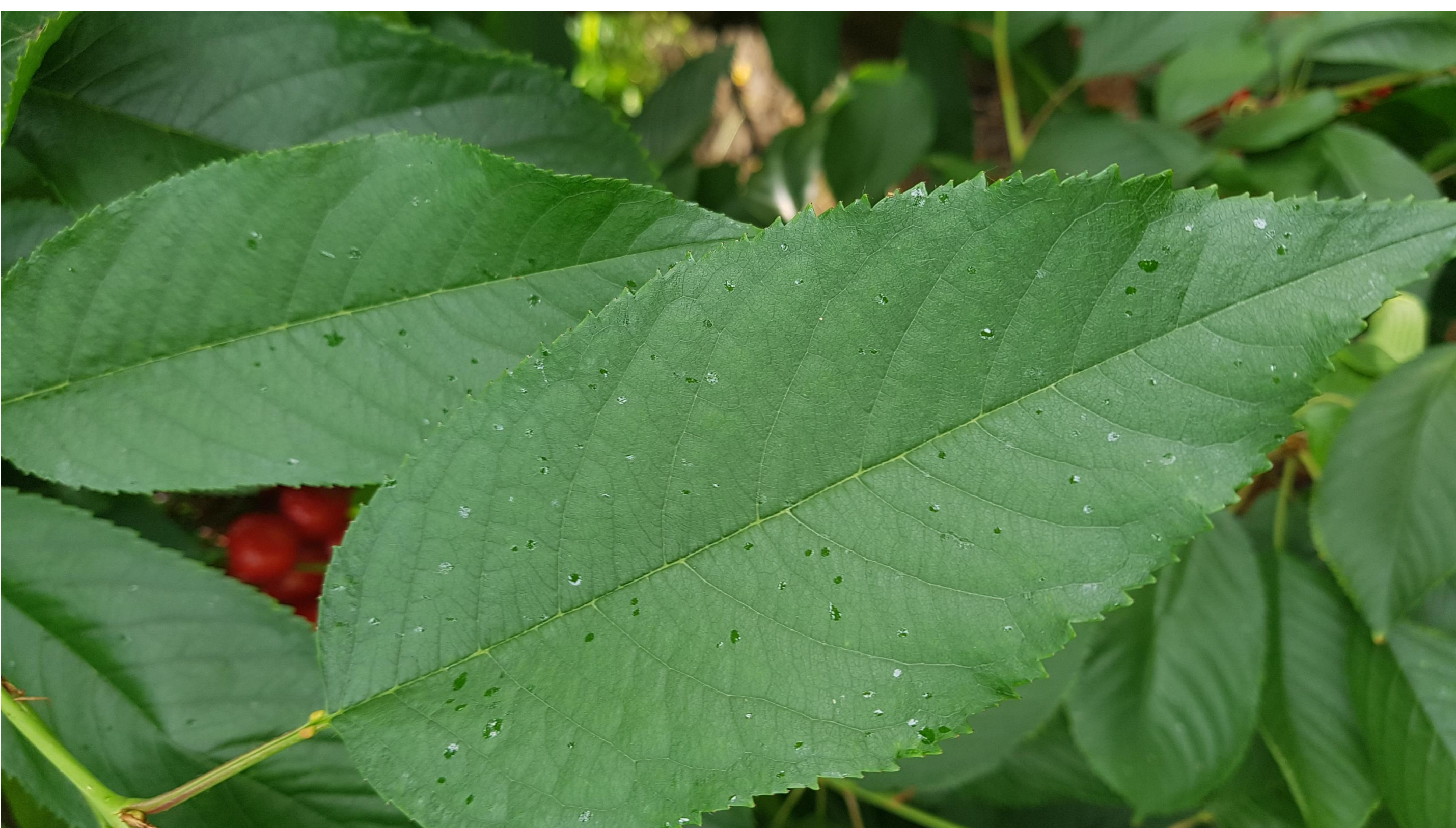
Foto: spuitdepositie op kersenblad, bij gebruik van venturidop zonder luchtondersteuning
